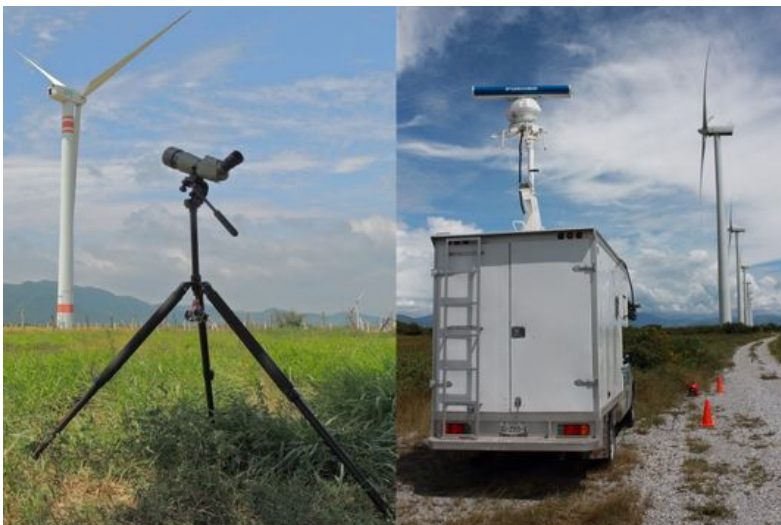
Figura 2. Telescopio (izquierda) y radar marino (derecha) empleados para el registro y conteo de aves; al fondo aerogeneradores de un parque eólico del Istmo.
