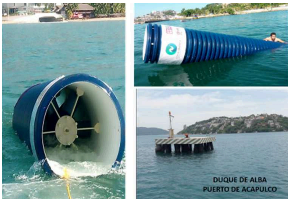
Figura 3. Dispositivo de aprovechamiento de oleaje instalado en octubre de 2018 en Acapulco, Guerrero. Fotografía: Rodolfo Silva, CEMIE-Océano
