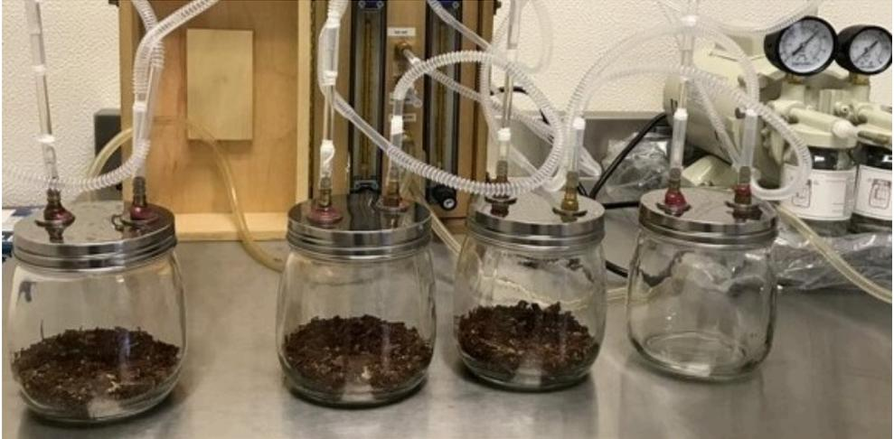
Figura 3. Colecta de volátiles de cortezas de árboles mediante aireación dinámica en laboratorio. Cada frasco contiene una muestra diferente, las mangueras inyectan aire purificado por un lado y extraen el aroma por el otro capturando el olor en un filtro que posteriormente es analizado para conocer su composición química. Fotografía: Roxana Y. Barrán
