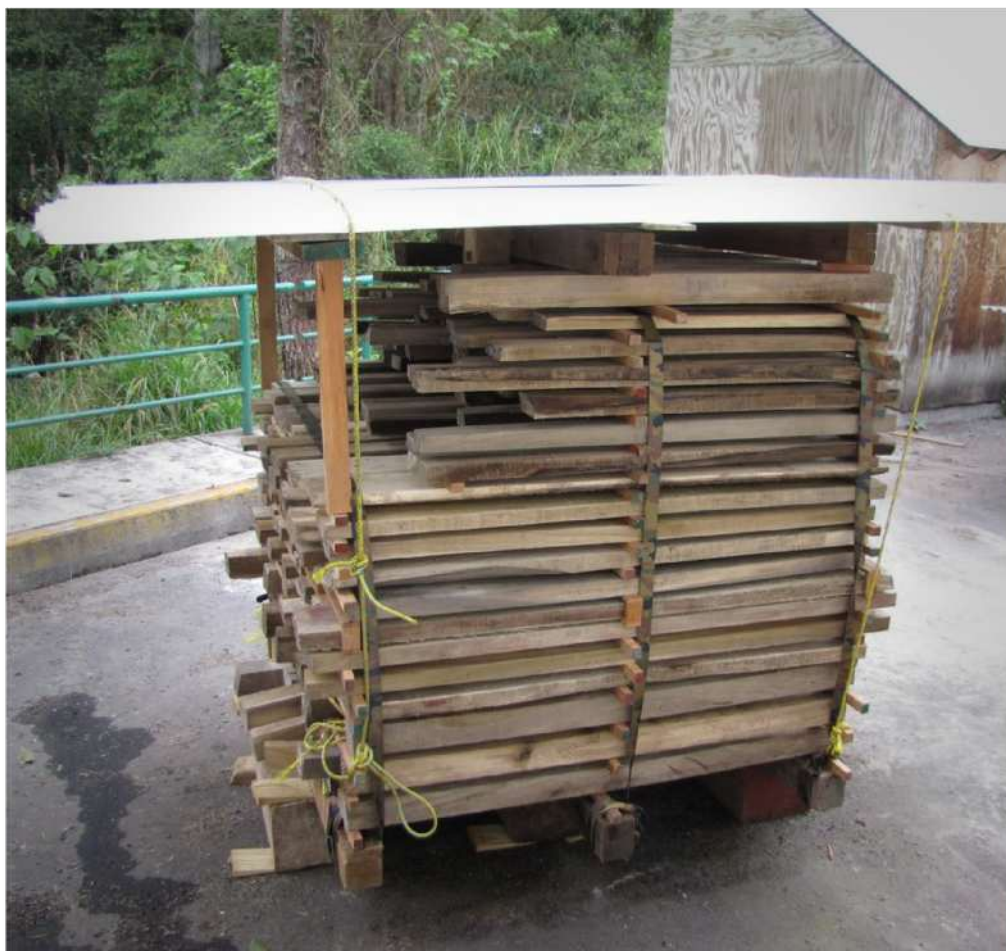
Figura 1. Pila de secado al aire libre. Fotografía: Raymundo Dávalos Sotelo
