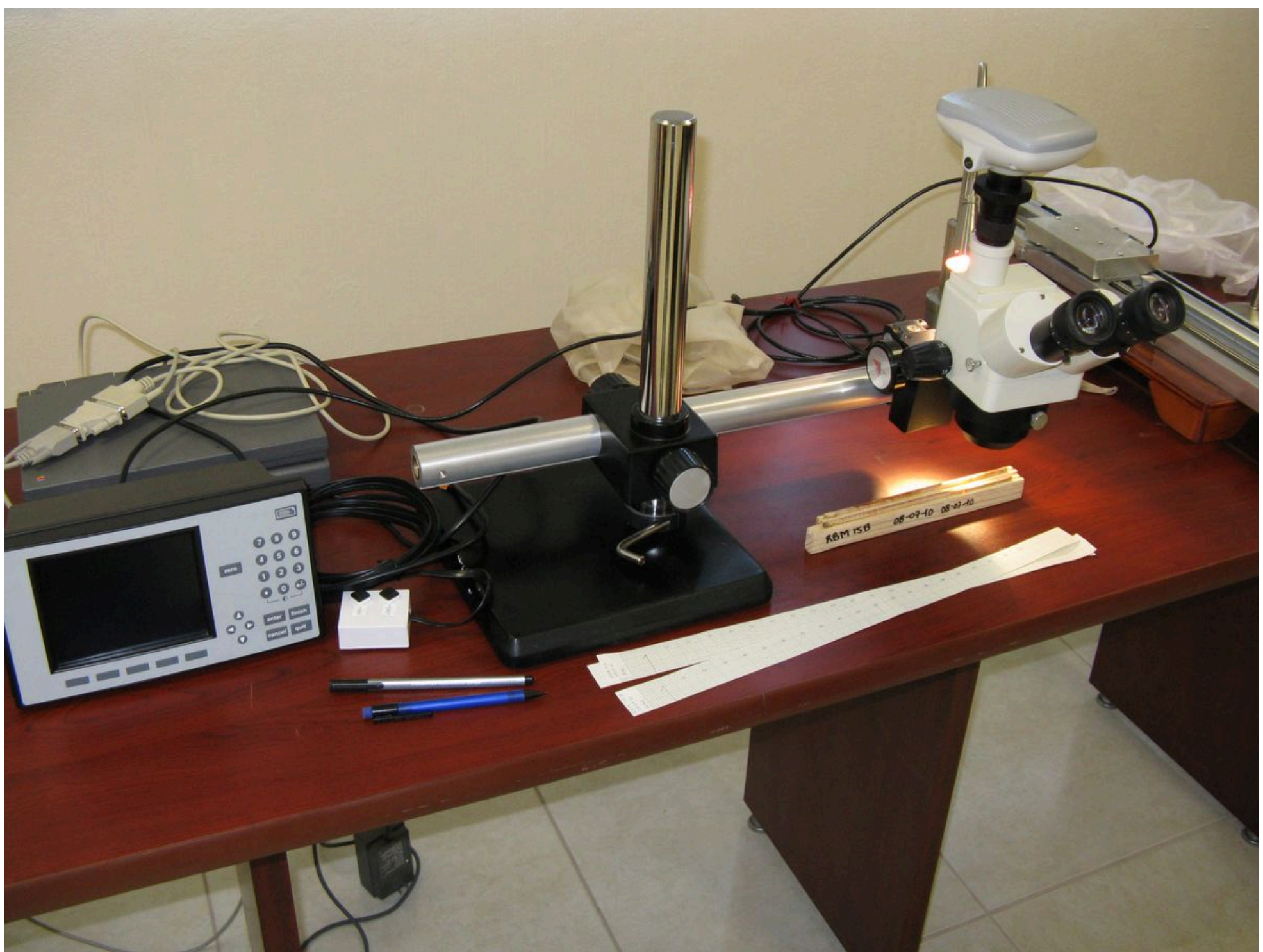
Equipo para medición de anillos de crecimiento, del laboratorio CENID-RASPA del INIFAP, Gómez Palacio, Durango, 2010. Fotografía: Alexandro Medina Chena
