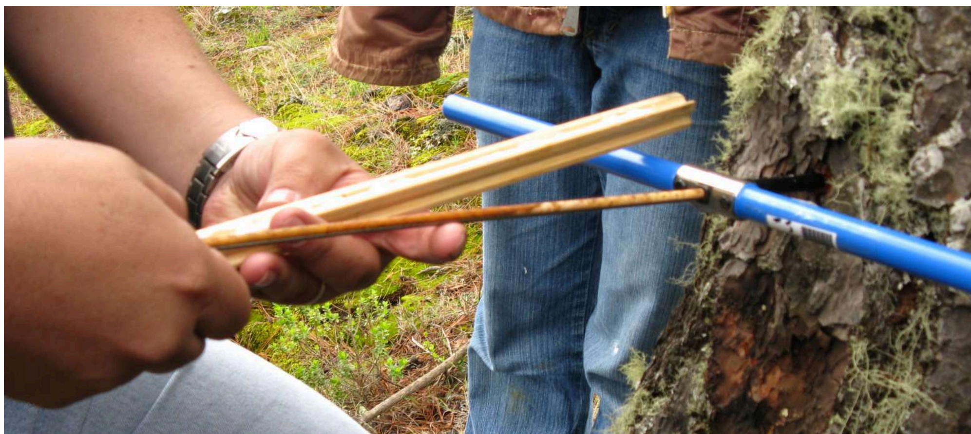
Obtención de muestra para medición de anillos de crecimiento en pino ocote ( Pinus teocote ) en El Volcancillo, Veracruz. 2008. Fotografía: Alexandro Medina Chena
