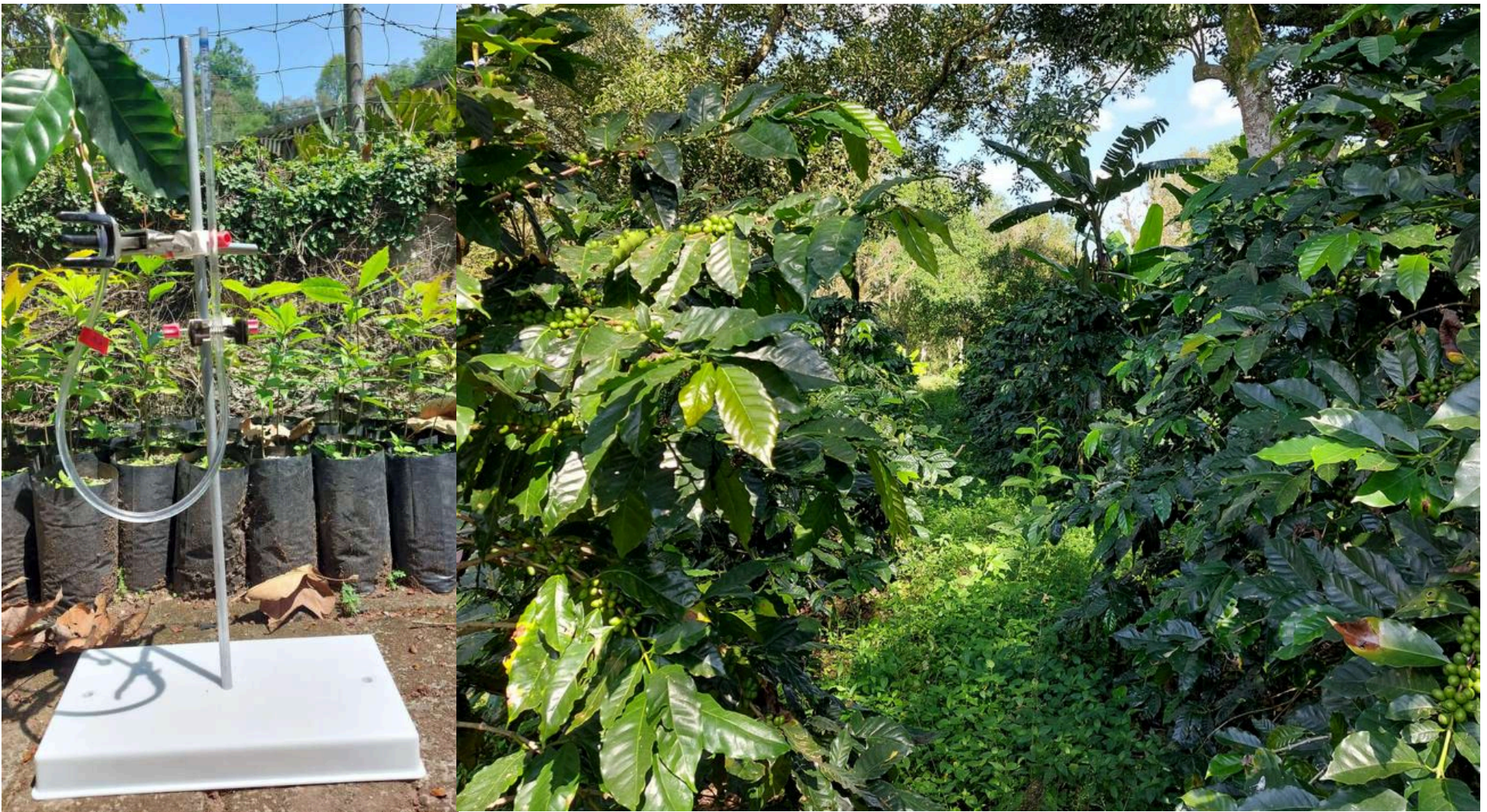
En plantas pequeñas se utiliza el potómetro. En campo se utilizan métodos llamados termométricos. Fotografías: Esveidy Ramírez
