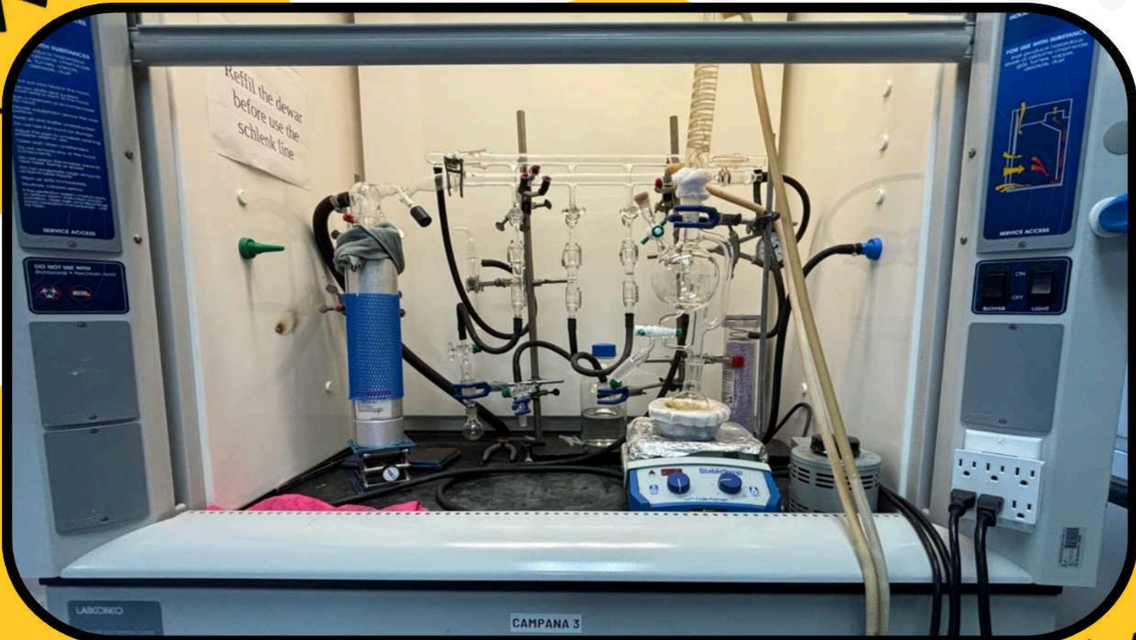
Sistema de alto vacío en campana de extracción
